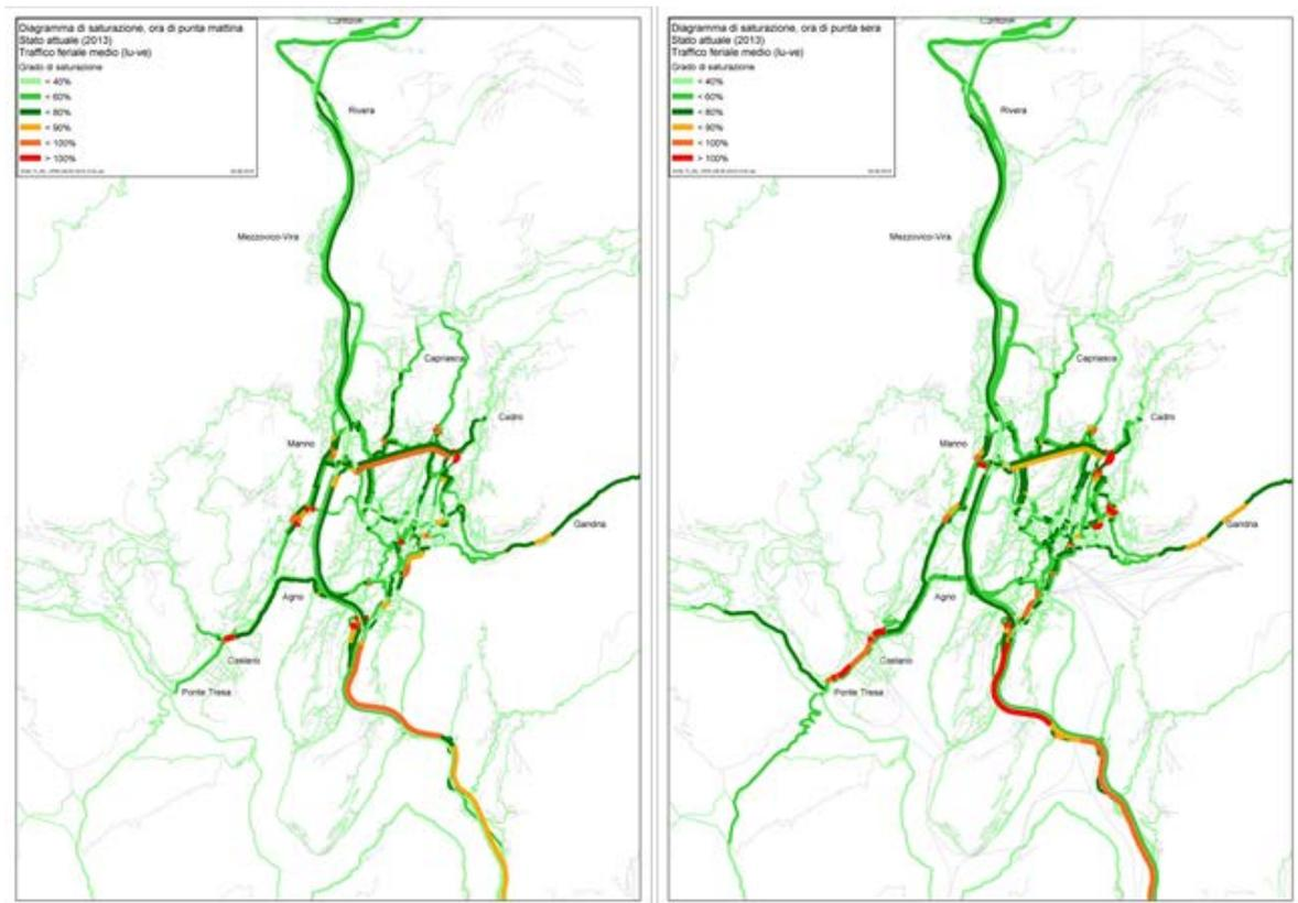
Figura 119 Diagramma di saturazione OPM/OPS - situazione 2013 (fonte modello del traffico, elaborazione Brugnoli e Gottardi SA)
